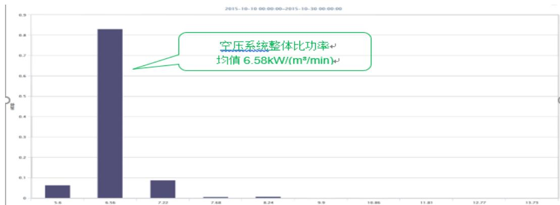
**优化成果：**通过上述优化控制策略的落实，企业空压系统比功率均值下降至  $6.58\text{kW}/(\text{m}^3/\text{min})$ ，压缩空气单耗降低 8.74%。按照 2014 年空压系统用电量 510.93 万 kWh 计算，优化后企业空压系统节省电量 44.64 万 kWh，节约电力成本近 37.95 万元。
