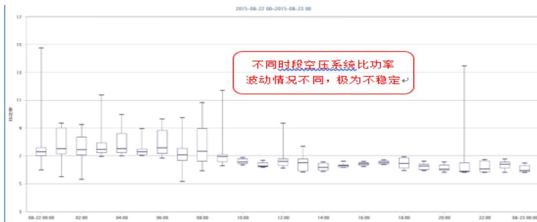
**解决措施：**基于空压系统长期压缩空气生产量数据，确定 5 台空压机的产气量就完全能满足企业压缩空气的需求量，故选择将其中一台比功率最高的空压机作为备用。启用变频设备，将配有变频器的空压机作为满足企业压缩空气需求量变化的辅助设备。同时设定各空压机参数，针对不同压缩控制需求量分别制定对应的控制策略，确保供需平衡的同时，保证空压系统持续处于最佳运营状态。对企业空压系统进行全面地审计，排查企业空压系统漏气及空压机运营环境情况，确保空压体系运作优良。
